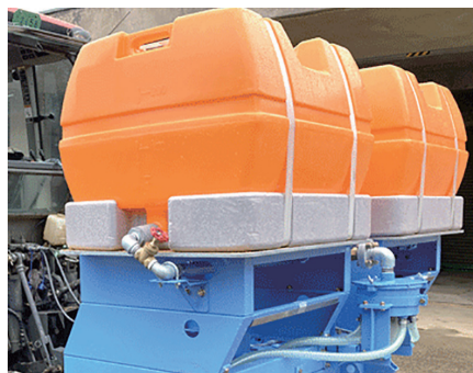
▲ タンク上部から注入 施工時は両方のバルブを全開
